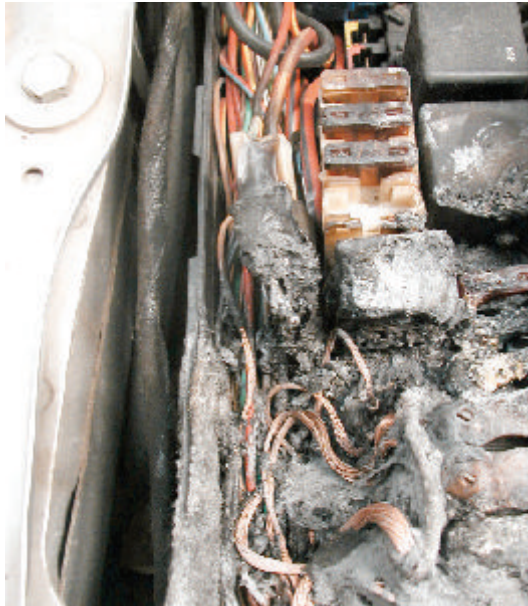
Anyagvesztés a személygépkocsi biztosítékdobozában – középen a tüzet okozó „lengő biztosíték”
