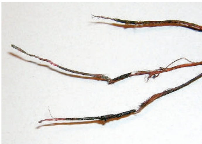
Rendellenes elváltozások nyomai a vezetékeken
