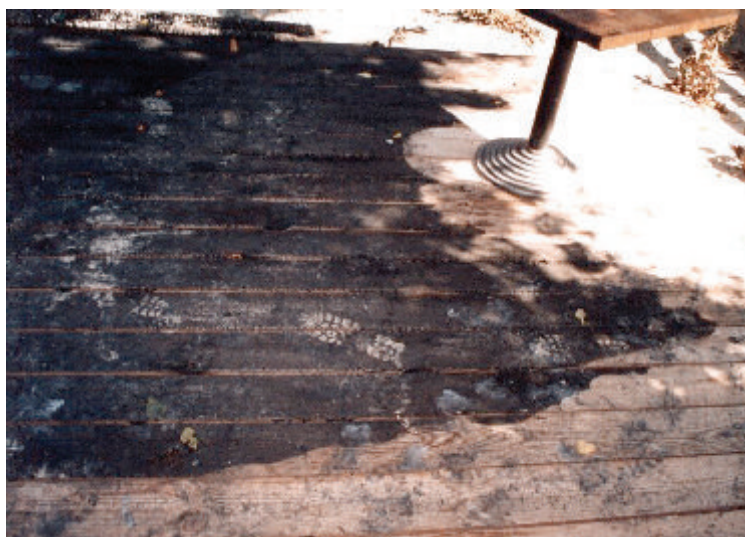
Égésnyomok az éghető folyadék folyási, beszívódási határaival
