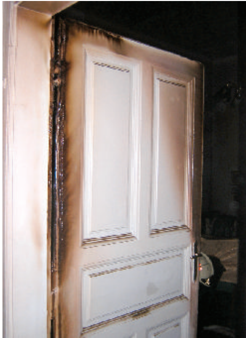
A tűz idején zárt ajtó külső szélein látható égésnyomok
