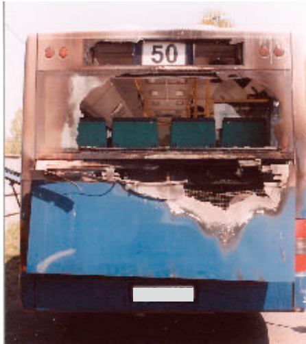
A motorháztetőn látható „V” alakú nyom alsó pontja környékén kell keresni a tűz keletkezési helyét
