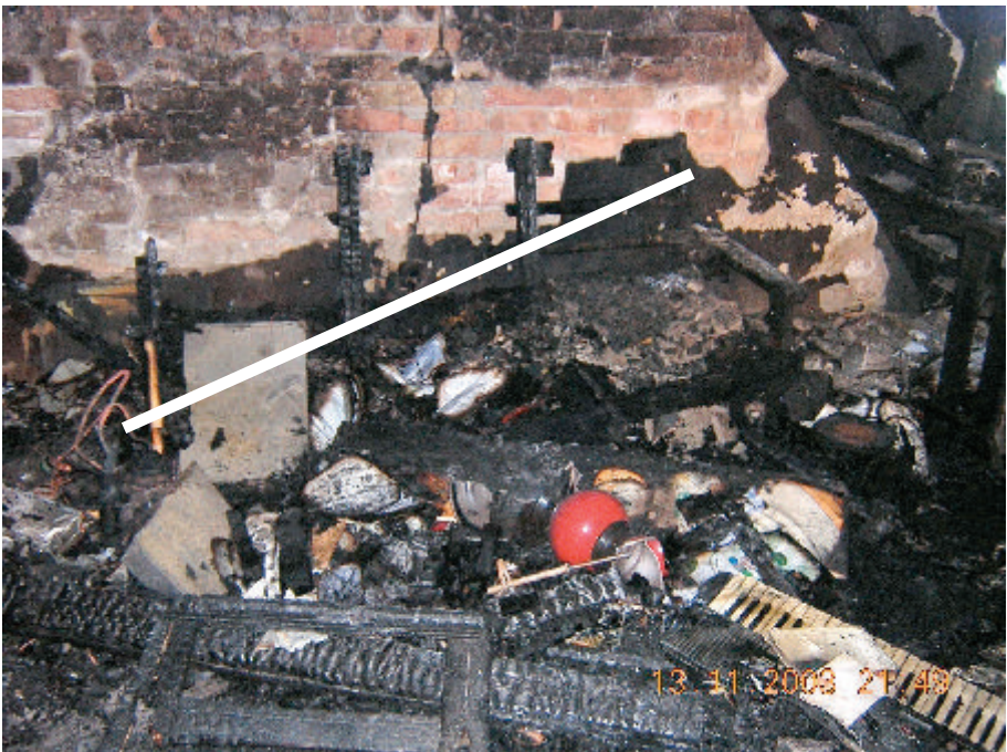
A kanapé maradványain látható nyíl alakú nyom azt mutatja, hogy a tűz a kép bal oldalán viszonylag alacsonyan keletkezett
