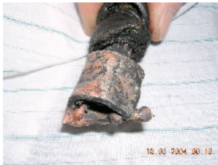
Elektromos áram hatására létrejött olvadási nyom egy önindító kábelsaruján
