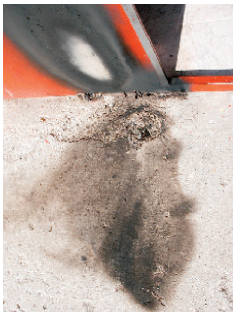
Az ajtó mellett szándékosan okoztak tüzet. A megolvadt műanyag flakonból kifolyó égő folyadék jellegzetes égésnyoma
