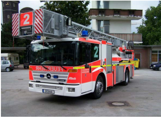
30. ábra: Metz DLK 23-12 gépezetes tolólétra Mercedes-Benz Econic 1828 LL alvázon. Forrás: http://bos-fahrzeuge.info
