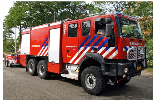
29. ábra: Ziegler gyártmányú, Tankautospuit-Waldbrand (TS7-BT) típusú nehéz erdőtűzoltó gépjármű, Iveco Euro Trakker MP 380 E 440 W 6x6 alvázon. Forrás: http://bos-fahrzeuge.info
