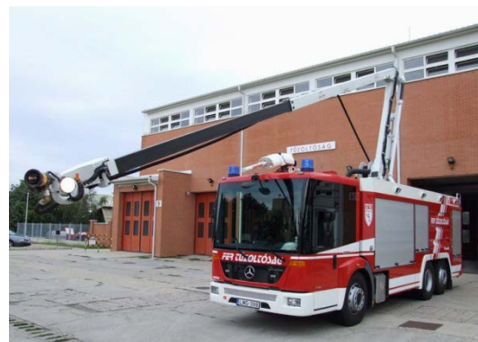
27. ábra: Mercedes Econic 2633 Rosenbauer ULF 4000/1500/1500 HRET univerzális oltógépjármű. FER létesítményi tűzoltóság szere. Forrás: http://www.policecars.hu
