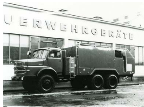
14. ábra: Rosenbauer gyártmányú nehéz ARFF repülőtéri tűzoltó gépjármű 1965-ből. Forrás: http://www.rosenbauer.com
