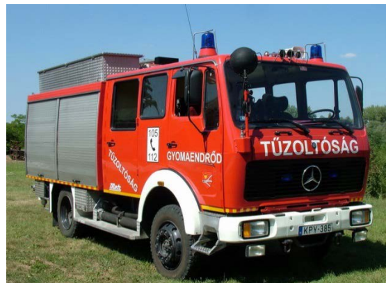
40. ábra: A gépjárműfejlesztés során beszerzett 1979 évi gyártású Mercedes-Benz 1019AF TLF 16/25 Metz középkategóriás gépjárműfecskeendő. Felújítás után a Hunyai, Csárdaszállási, Gyomaendrődi Önkéntes Tűzoltóság gépjárműveként. Forrás: saját kép
