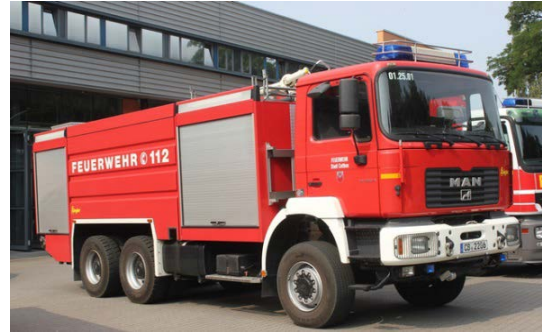
25. ábra: Ziegler gyártmányú MAN FE 360 A GTLF 24/95-5 vízszállító gépjármű 2002-ből. Cottbus Hivatásos Tűzoltóság szere. Forrás: http://bos-fahrzeuge.info
