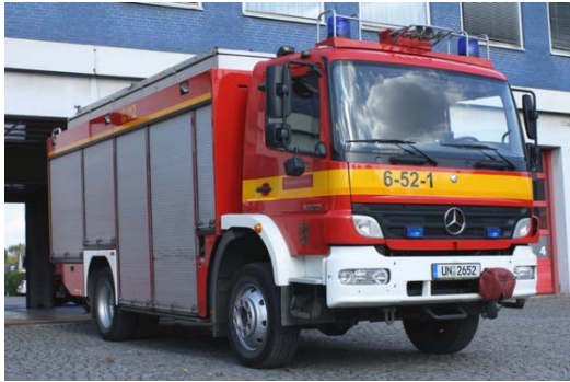
32. ábra: Schlingmann gyártmányú RW 2 közepkategóriás műszaki mentő gépjármű Mercedes-Benz Atego 1528 AF alvázon. Forrás: http://bos-fahrzeuge.info
