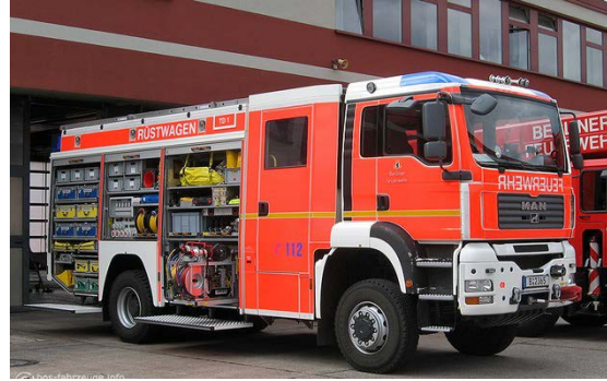
33. ábra: Rosenbauer gyártmányú RW 3 nehéz műszaki mentő gépjármű MAN TGA 18.350 alvázon. Forrás: http://bos-fahrzeuge.info
