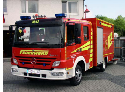
39. ábra: Schlingmann gyártmányú GW-L1 tűzoltó tehergépjármű Mercedes-Benz Atego alvázon. Forrás: http://bos-fahrzeuge.info
