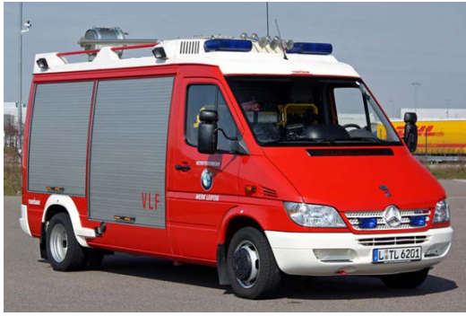
22. ábra: Rosenbauer gyártmányú, Mercedes-Benz Sprinter 416CDI típusú alvázra szerelt VLF típusú gyorsbeavatkozó gépjármű a BMW létesítményi tűzoltóságától. Gyártási év: 2003. Forrás: http://bos-fahrzeuge.info
