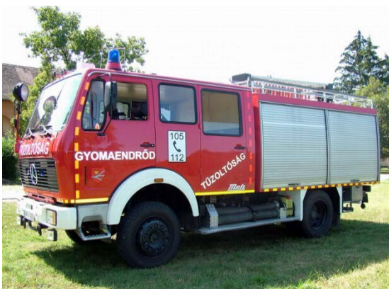
40. ábra: A gépjárműfejlesztés során beszerzett 1979 évi gyártású Mercedes-Benz 1019AF TLF 16/25 Metz középkategóriás gépjárműfecskeendő. Felújítás után a Hunyai, Csárdaszállási, Gyomaendrődi Önkéntes Tűzoltóság gépjárműveként. Forrás: saját kép
