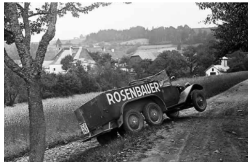
6. ábra: Tatra alvázra épített, Rosenbauer gyártmányú összkerék-hajtású, terepjáró tűzoltó gépjármű 1930-ból. Forrás: http://www.rosenbauer.com
