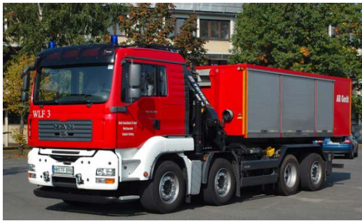
36. ábra: Meiller gyártmányú csere-felépítményes gépjármű MAN TGA 35.360 alvázon. Forrás: http://bos-fahrzeuge.info
