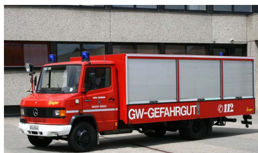
35. ábra: Zielger gyártmányú GW-G/Öl közepes vegyi-olajbaleseti gépjármű Mercedes-Benz 811 D alvázon. Forrás: http://bos-fahrzeuge.info
