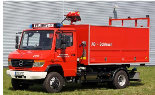
37. ábra: Heinz Meyer Feuerwehrbedarf GmbH gyártmányú csere-felépítményes gépjármű Mercedes-Benz Vario 818 DA alvázon. Forrás: http://bos-fahrzeuge.info
