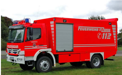
38. ábra: Schlingmann gyártmányú GW-L2 tűzoltó tehergépjármű Mercedes-Benz Atego alvázon. Forrás: http://bos-fahrzeuge.info
