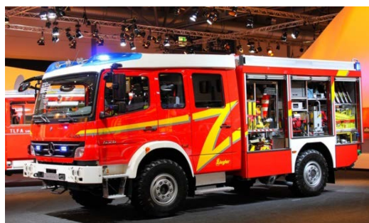
21. ábra: Ziegler gyártmányú, Mercedes-Benz Atego 1226 AFE típusú alvázra szerelt LF 10/6 típusú gépjárműfecske. Gyártási év: 2010. Forrás: http://bos-fahrzeuge.info
