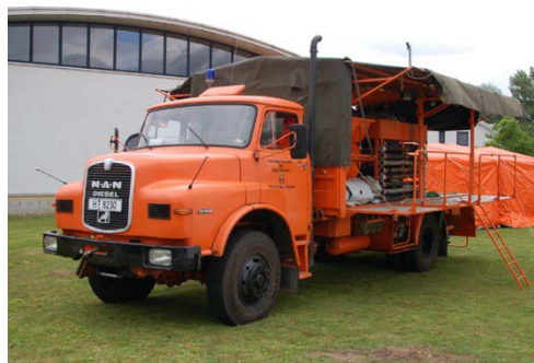
17. ábra: Odenwaldwerke gyártmányú MAN 13.168 HA típusú alvázra szerelt vegyi mentesítő jármű (Dekon) 1966-ból. Forrás: http://bos-fahrzeuge.info
