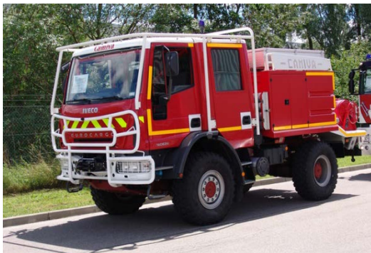
28. ábra: Camiva CCFM 4000 erdőtűzoltó gépjármű Iveco 140 E 24 alvázon. Forrás: http://bos-fahrzeuge.info
