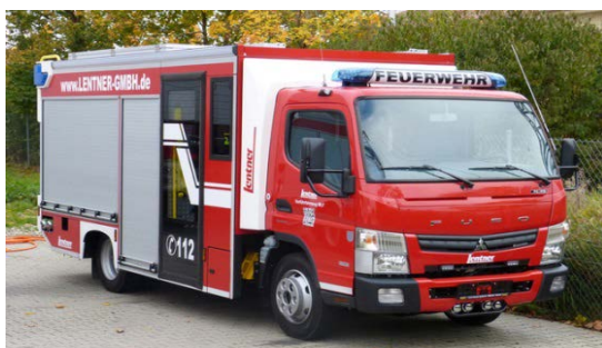
20. ábra: Lentner gyártmányú, Mitsubishi Fuso Canter 7 C 18 D típusú alvázra szerelt MLF típusú gépjárműfecske. Gyártási év: 2013. Forrás: http://bos-fahrzeuge.info
