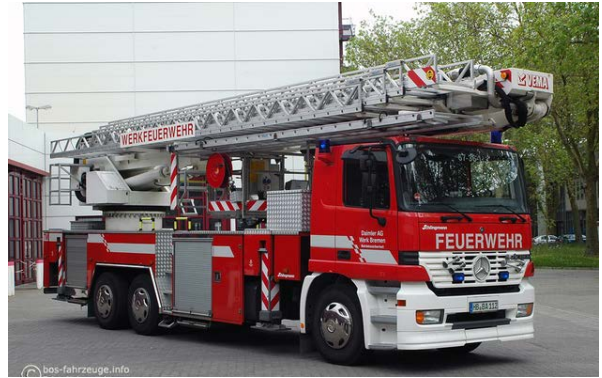
31. ábra: Vema / Schlingmann gyártmányú TMB 45 emelőkosaras gépjármű Mercedes-Benz Actros 3335 6x4 alvázon. Forrás: http://bos-fahrzeuge.info
