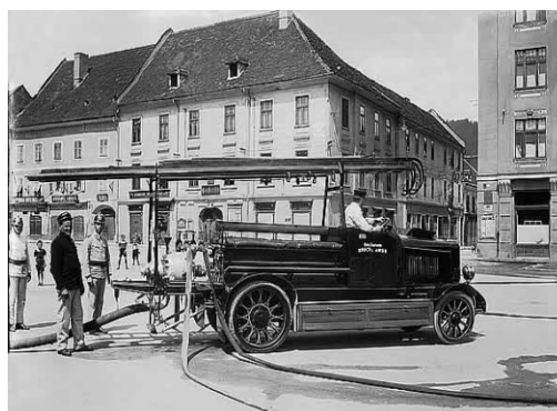
5. ábra: Rosenbauer gyártmányú tűzoltó gépjárműfecskendő, 1920-ból, Graef & Stift D280 típusú gépjármű felhasználásával, 1000 liter/perc teljesítményű beépített szivattyúval. Forrás: http://www.rosenbauer.com
