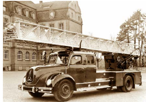
13. ábra: Magirus gyártmányú 52 méter munkamagasságú gépezetes tolólétra 1951-ből. Forrás: http://www.iveco-magirus.com
