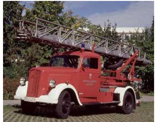
9. ábra: Magirus gyártmányú DL18 típusú gépezetes tolólétra Opel Blitz alvázon 1939-ből. Forrás: http://www.iveco-magirus.com
