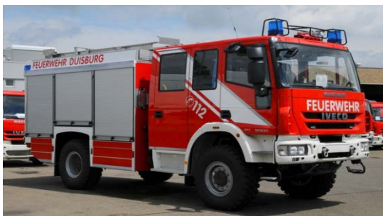
18. ábra: A Dusburg-i hivatásos tűzoltóság Magirus gyártmányú, Iveco FF 150 E 30 W típusú alvázra szerelt HLF 20 típusú gépjárműfecskeendője. Gyártási év: 2014. Forrás: http://bos-fahrzeuge.info
