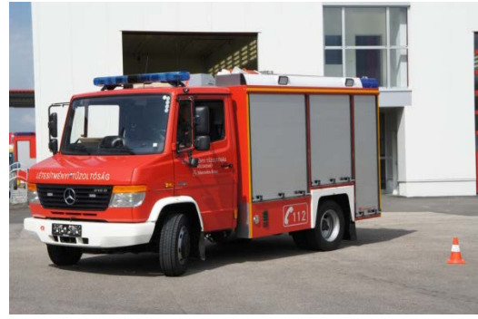
23. ábra: Rosenbauer gyártmányú, Mercedes-Benz Vario 816D típusú alvázra szerelt VLF 600/200 típusú gyorsbeavatkozó gépjármű a kecskeméti Mercedes-Benz gyár létesítményi tűzoltóságától. Gyártási év: 2012. Forrás: http://www.hesztia.hu
