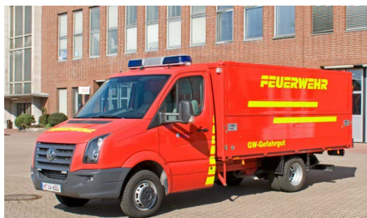
34. ábra: Metz gyártmányú GW-G könnyű vegyi gépjármű Volkswagen Crafter alvázon. Forrás: http://bos-fahrzeuge.info
