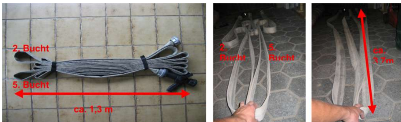
4. kép: az öblökbe hajtogatott tömlőcsomag és széthúzása tömlőtartalékká [Björn Lüssenheide: Verbesserung des Schlauchmanagement - Lösungsvorschlag Schlauchpakete; 4. oldal]
