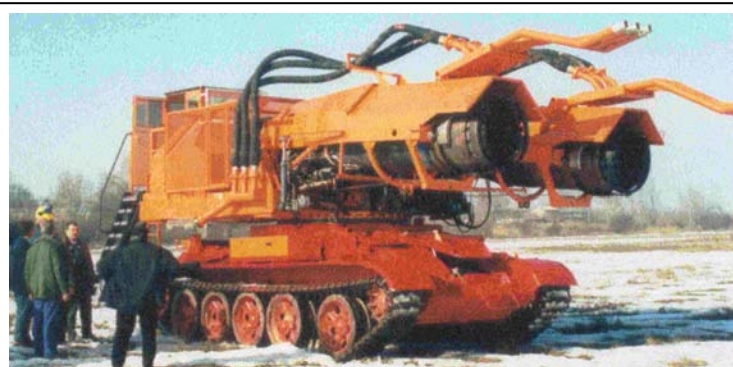
18. kép. A MiG-21 hajtóművekkel épített TRO
