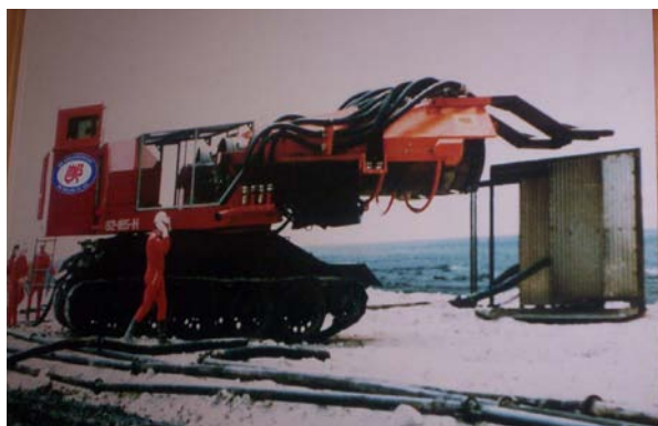
19. kép. A MiG-21 hajtóműves TRO oldalnézetben
