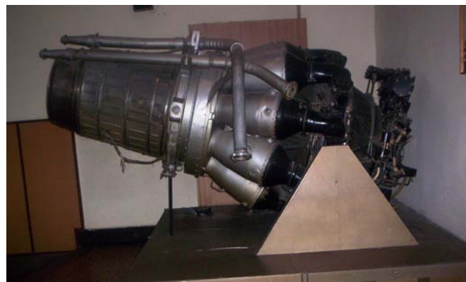
16. kép. A MiG-15 hajtóműves TRO oltóanyag ellátó része
