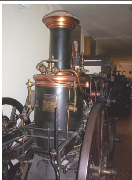
3. kép. A gőzfecskendő kazánja, és fűtőjének munkahelye
