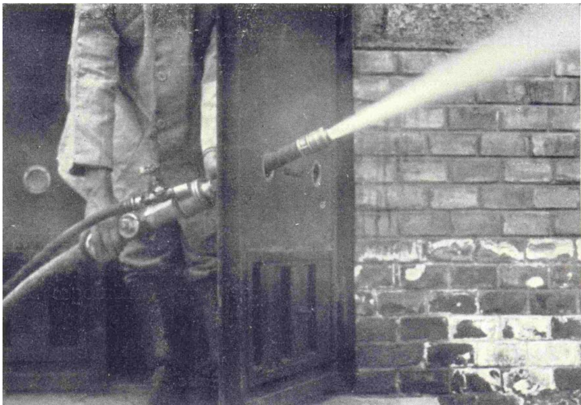
5. kép. Oltógáz porral, vagy porlasztott vízzel együtt jut az ajtó furatán keresztül a zárt térbe
