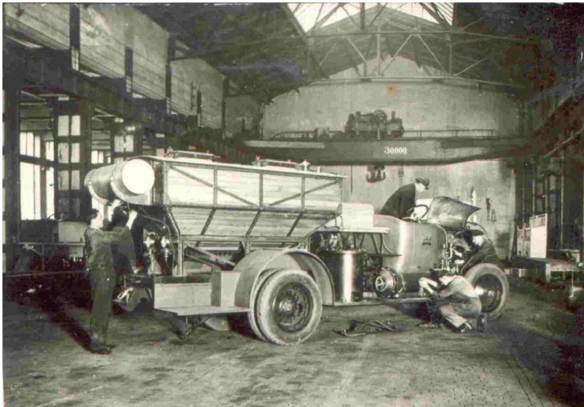
2. kép. Az első, még faputtonyos szárazoltógép szerelés közben
