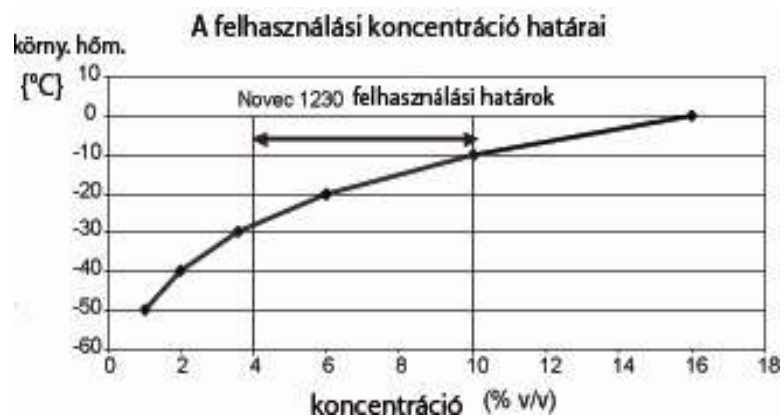
11. ábra – A NOVEC 1230 felhasználási koncentrációjának határai
