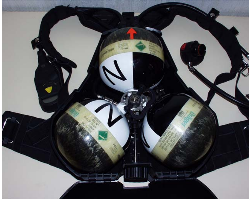
A palackegység elhelyezkedése a készülék házban
