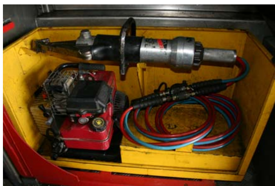
11. sz. kép: A Győr-1 gépjárműfecskendőn rendszeresített Lucas típusú mobil, kombi feszítő-vágó
