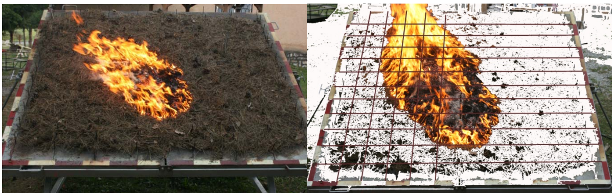
7.2. Ábra Terepasztal 9-es biomassa modell minta égetése, és értékelése
