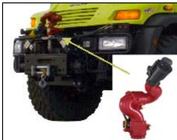
9.6. Ábra Távirvezérlésű monitorfej erdőtűzes Unimogon
