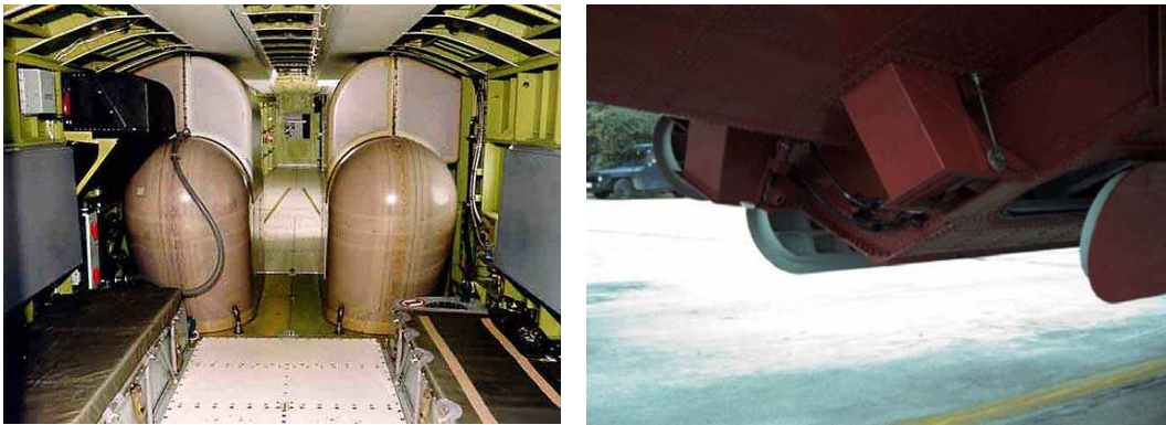
7. számú kép. CL-415 belső tartálya és kiömlő nyílása: Forrás: Internet.
