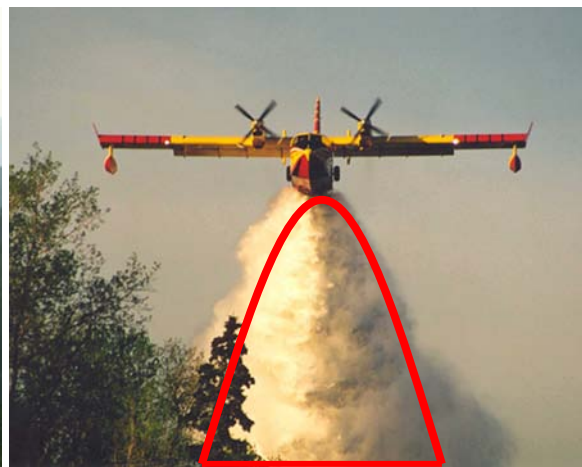
29. számú ábra. A kibocsátott oltóanyag szórásképének leegyszerűsített formái. Helikopterrel Bambi Bucket –ből és Canadair CL 415 repülőgépből. Forrás: szerző.
