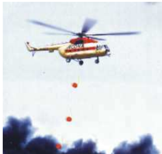
12. számú kép. Robbanó oltókészülék alkalmazása. Forrás: Benigno G.C.
