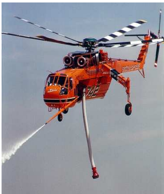
10. számú kép. Air-Crane S-64 helikopter speciális sugárcsővel. Forrás: Internet.
