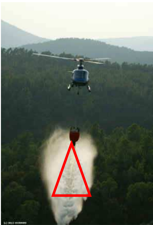
29. számú ábra. A kibocsátott oltóanyag szórásképének leegyszerűsített formái. Helikopterrel Bambi Bucket –ből és Canadair CL 415 repülőgépből. Forrás: szerző.
