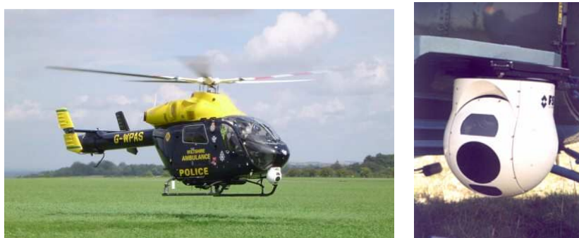
14. számú kép. Hőkamerával felszerelt EC-145 és MI-2 típusú helikopterek. Forrás: Internet, Belo-Caban.
