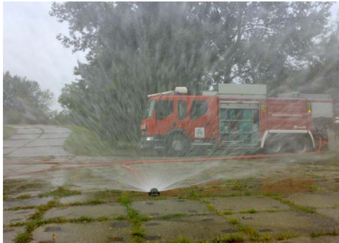
31. kép A vízpajzs által létrehozott vízfüggöny
