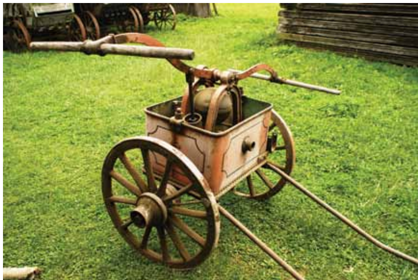
Petőfalva Teudloff-Dittrich típusú fecskendője. A szerző által készített felvétel
