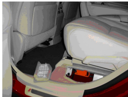
14. és 15. számú képek: Toyota és Lexus áramtalanító karok /Forrás: Nagy László tűő. alez.: A hibrid hajtású járművek áramtalanítása/
