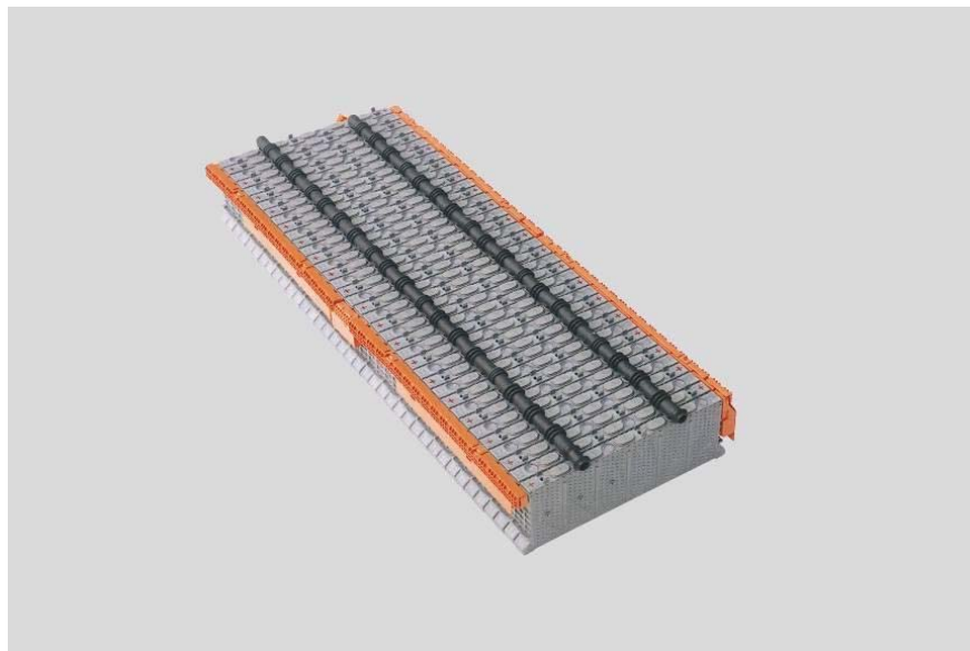
11. számú kép: Toyota Prius NiMH akkumulátor /Forrás: Karsa Róbert t. szds: Hibrid technológia és mentési taktika/
