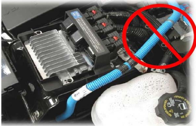
10. számú kép: A 2007-es Saturn VUE Hybrid nagyfeszültségű kábelei /Forrás: Saturn VUE Green Line Hybrid: Emergency Response Guide, 2007/
