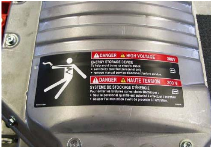
9. számú kép: Figyelmeztetés nagyfeszültségű rendszerre /Forrás: 2008 GMC Yukon: Emergency Response Guide/
