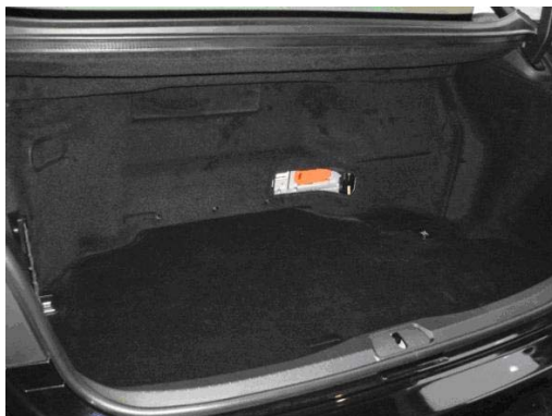
14. és 15. számú képek: Toyota és Lexus áramtalanító karok /Forrás: Nagy László tűő. alez.: A hibrid hajtású járművek áramtalanítása/
