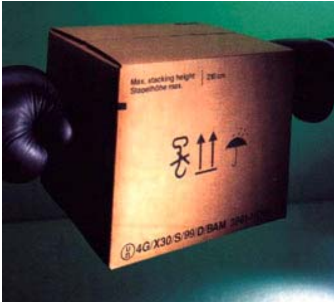
18. Kép A minősített csomagolások 3 méterig halmazolhatók
