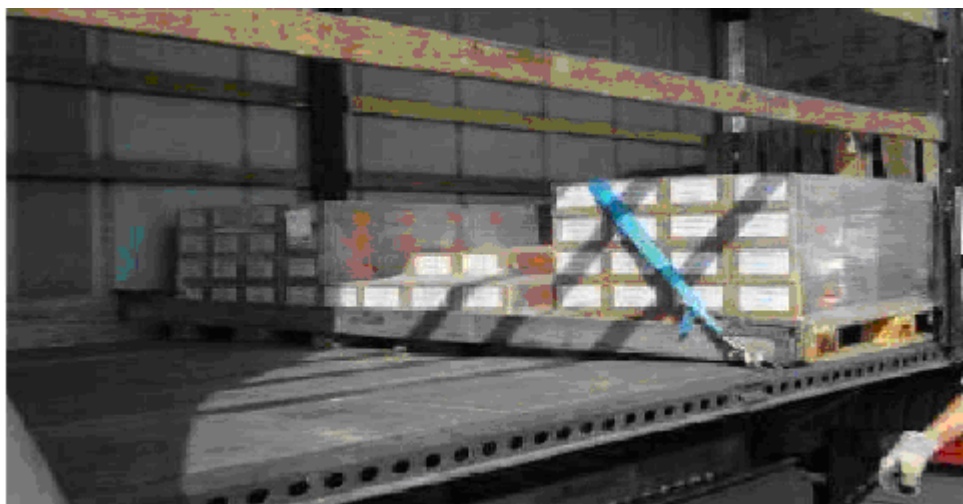
22. Kép Csúszásgátlás nélküli, gyenge rögzítés (árutömeg kb.: 2.5 t)
