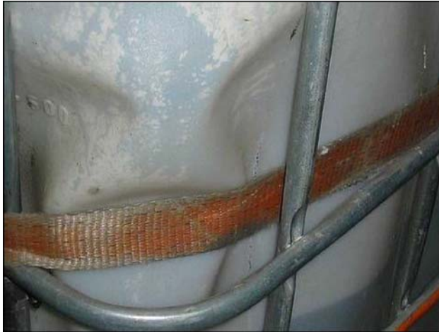
41. Kép Heveder által deformálódott IBC
