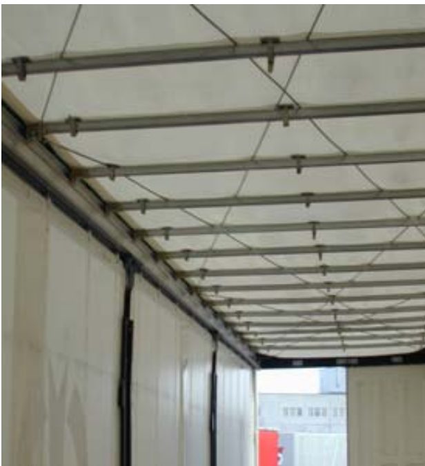
35. Kép Integrált drótköteles stabilizáló
