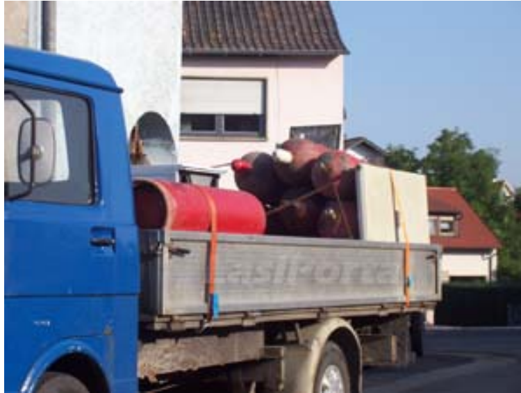
3. Kép: Üres tisztítatlan gázpalackok, hordók szabálytalan rakomány elhelyezése, rögzítése
