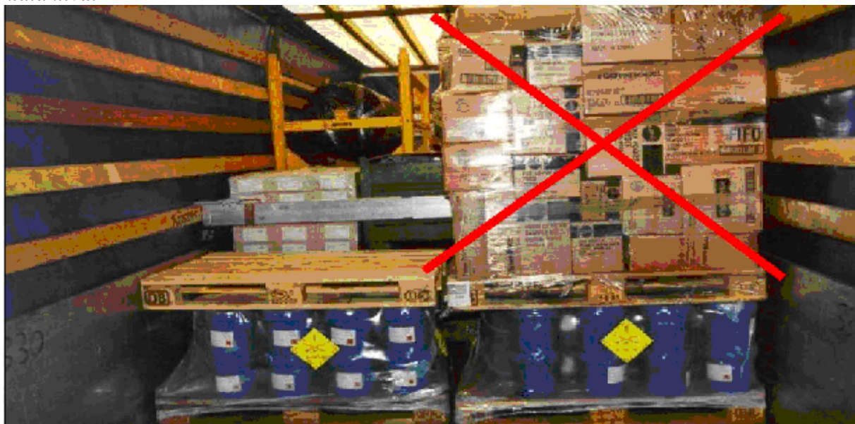
42. Kép Az alsó darabáru egységen halmazolási tilalmi kezelési jelzet található
