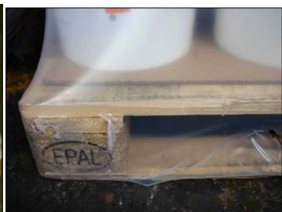
21. Kép Raklaptalp alá húzott fóliával csökken a tapadási jellemző
