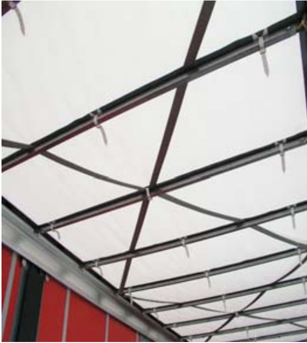
36. Kép Integrált mesterséges szálú kötél stabilizáló
