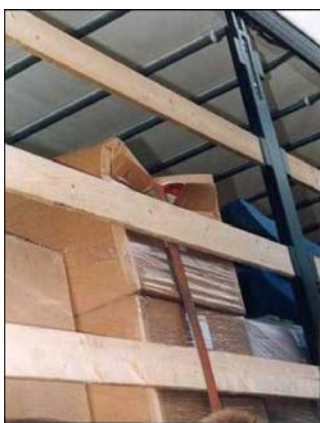
17. Kép Heveder által deformálódott csomagolás
