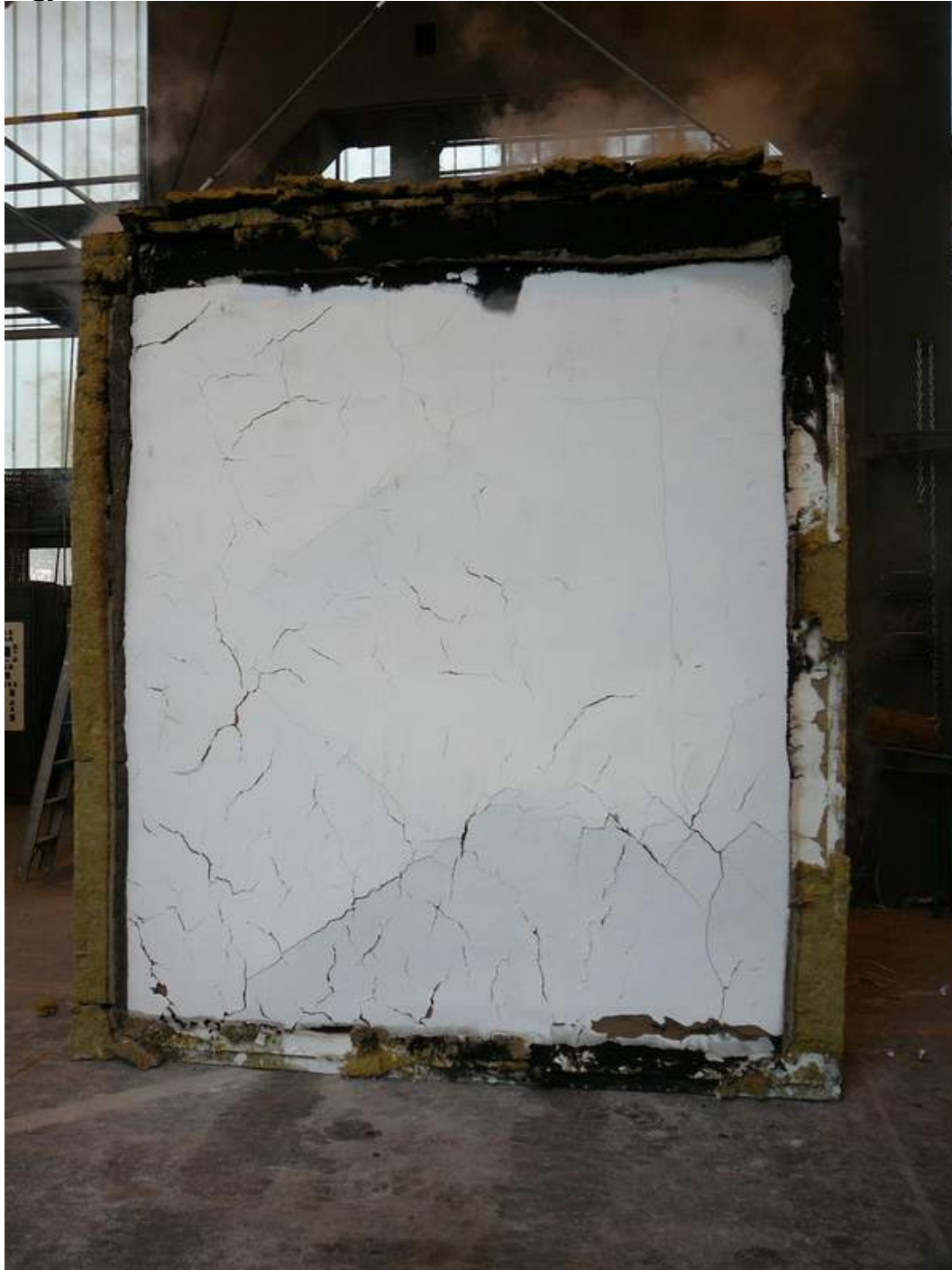
Szalmabála fal tűztérben lévő oldala a vizsgálat után
