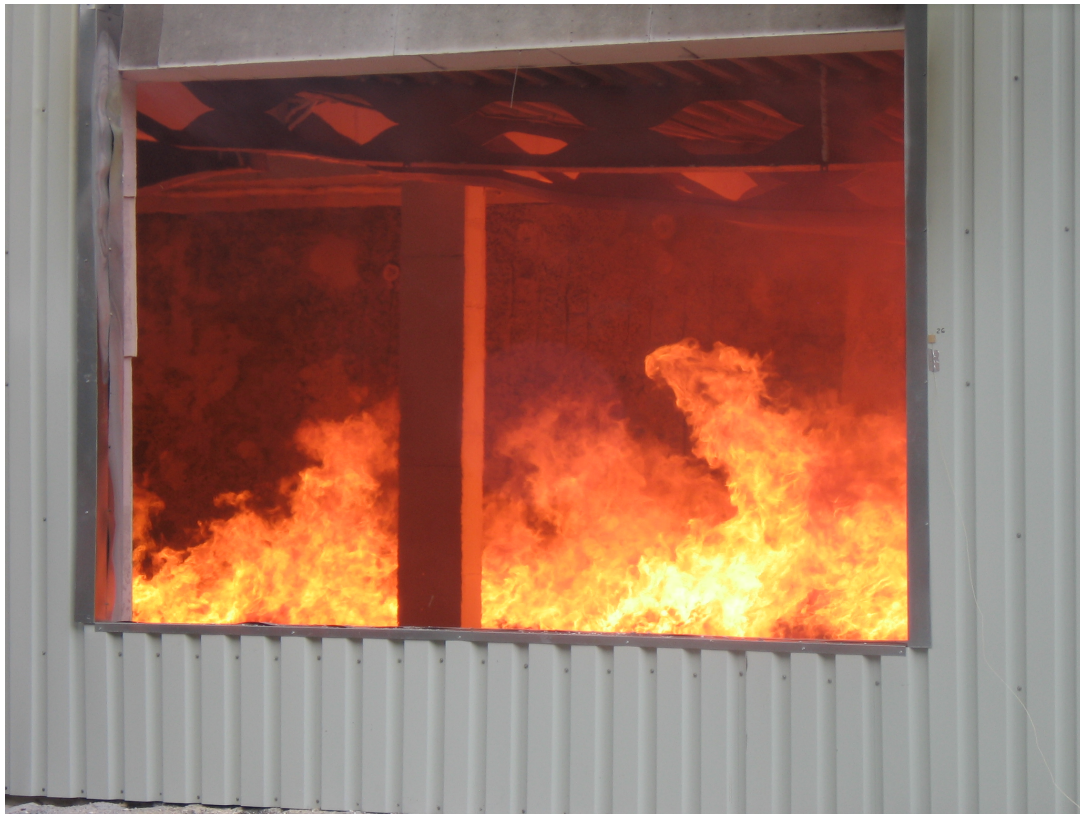
Prága tűzteszt – A könnyített acélgerendák meghajoltak
