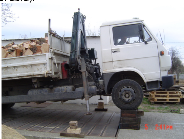
3. ábra A gépkocsi súlypont magasságának meghatározásához elvégzett mérés
