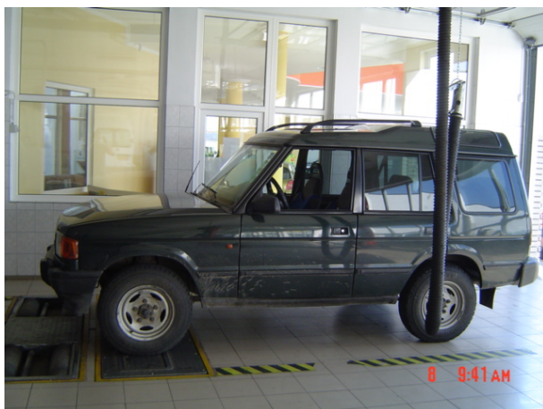
2. ábra A gépkocsi keresztirányú súlyponti koordinátájának meghatározásához végzett mérés
