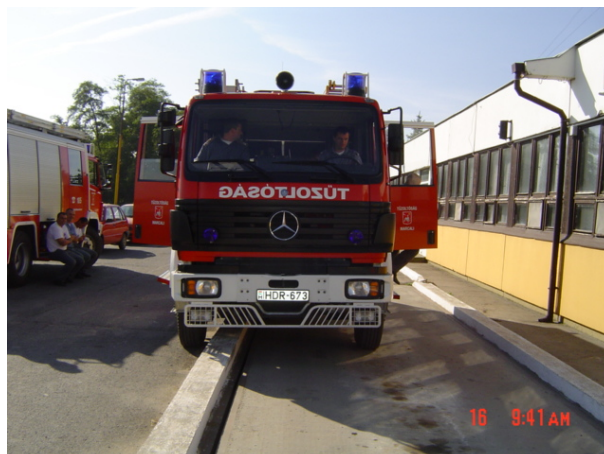
1. ábra A gépkocsi keresztirányú súlyponti koordinátájának meghatározásához végzett mérés
