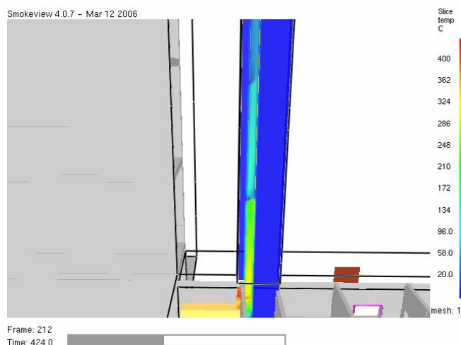
22. ábra A tiszta szellőző csőben kialakult hőmérséklet a 424s-ban
