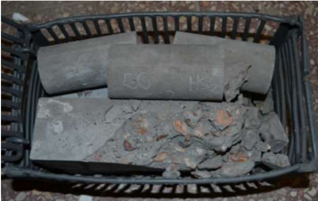
5. ábra: 1000°C hőterhelést követően az épen maradt henger alakú próbatestek, illetve a tönkrement hasáb alakú próbatestek
